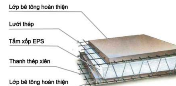
Cấu tạo Tấm sàn, trần 3D
